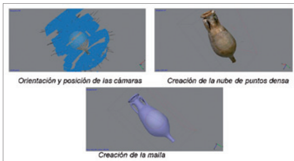
Figura 10. Fases del procesado en fotogrametría de un ánfora procedente del pecio Bou-Ferrer con PhotoScan de Agisoft
